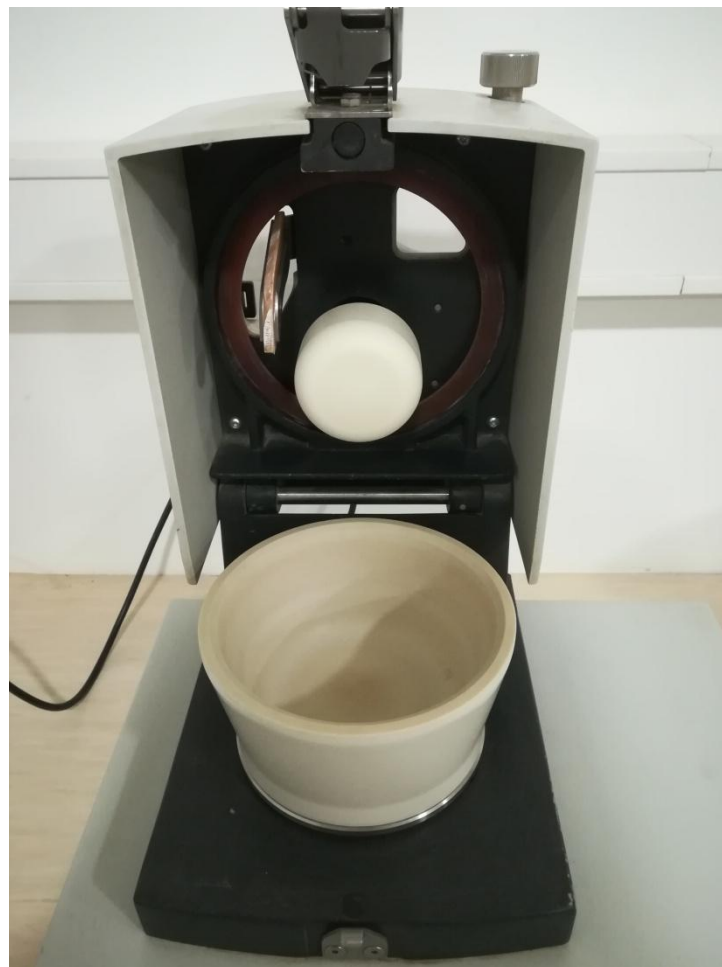
Slika 6. Mlin za mljevenje uzorka ječma (Izvor: autor)
