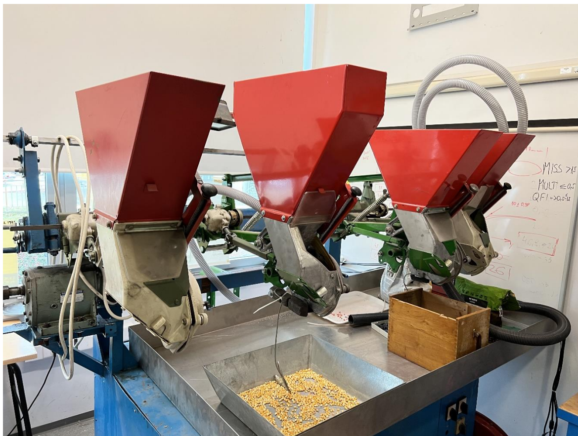
Slika 10. PSK4 sijačica na ispitnom stolu
