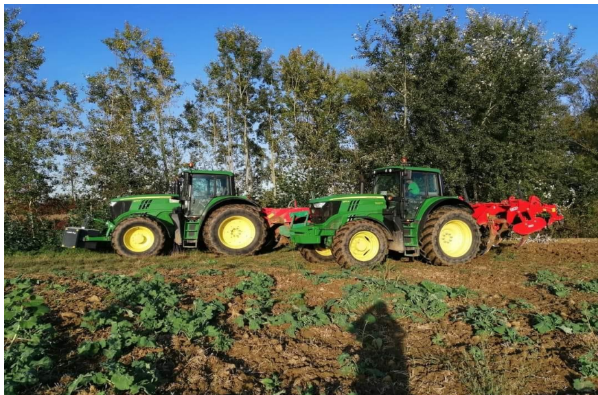
Slika 6. Agregati za predsjetvenu pripremu (Izvor: Antun Nikolić)
