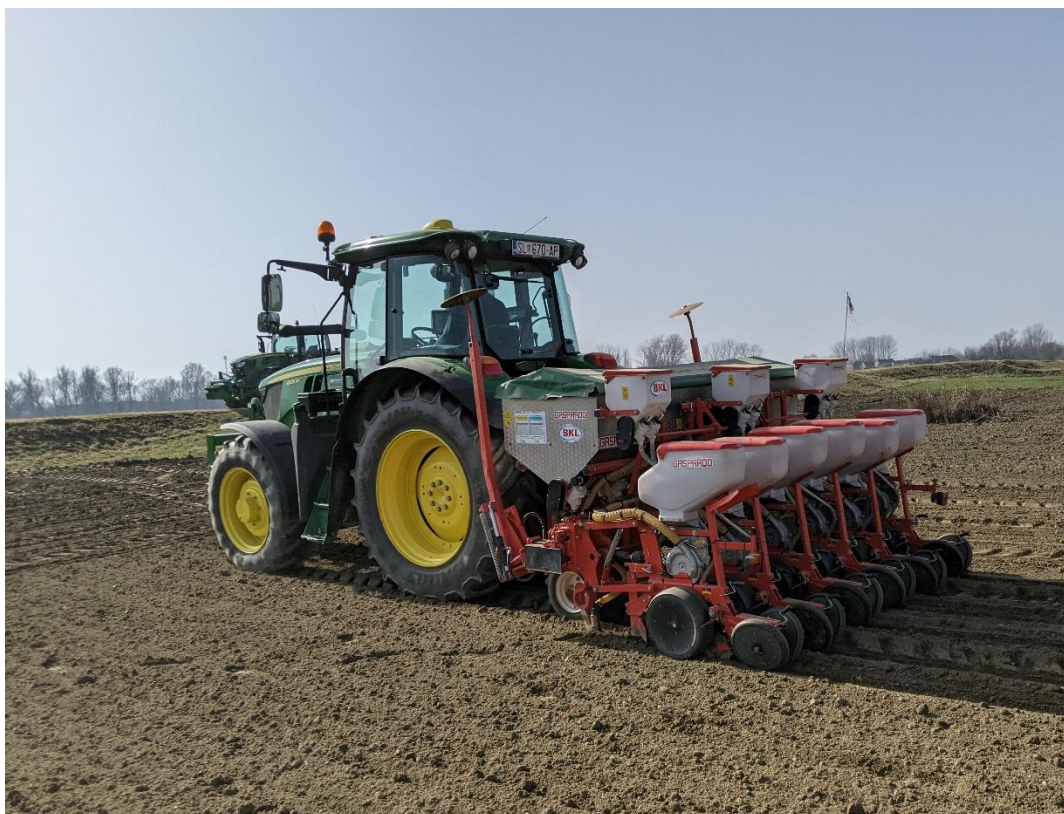
Slika 11. Sjetva varijante I šesterorednom pneumatskom sijačicom
