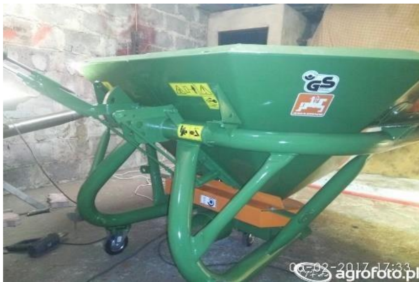
Slika 17. Raspodjeljivač mineralnog gnojiva Amazone ZAF 603 (Izvor: https://www.agrofoto.pl/forum/gallery/image/677447-amazone-zaf-603/ )
