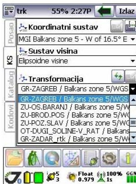
Slika 6. Prikaz displaya trk sustava - postavljanje koordinatnog sustava
