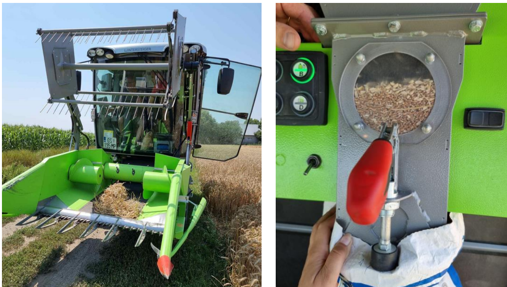
Slika 4. Vršenje uzoraka pšenice i ispuštanje u vreće (izvor: Marinić, M.)
