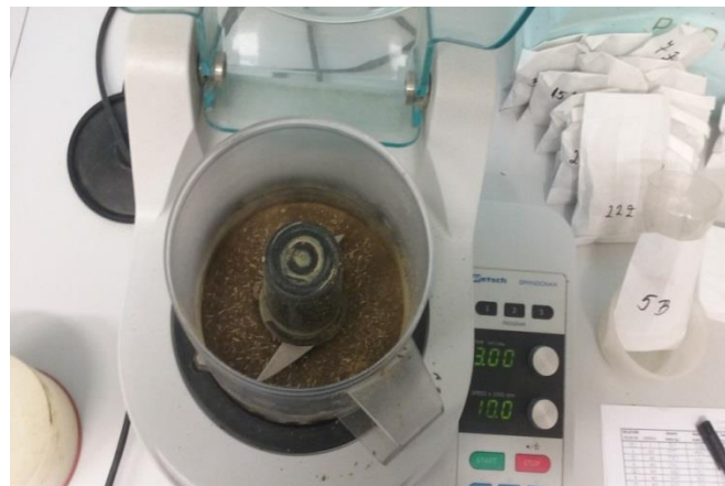
Slika 4. Usitnjavanje uzoraka lucerne u heavy metal free mlinu
