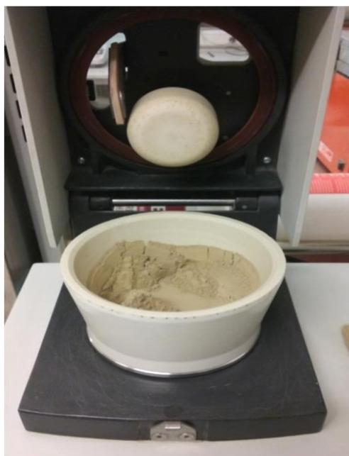
Slika 2. Uzorak tla iz heavy metal free mlina
