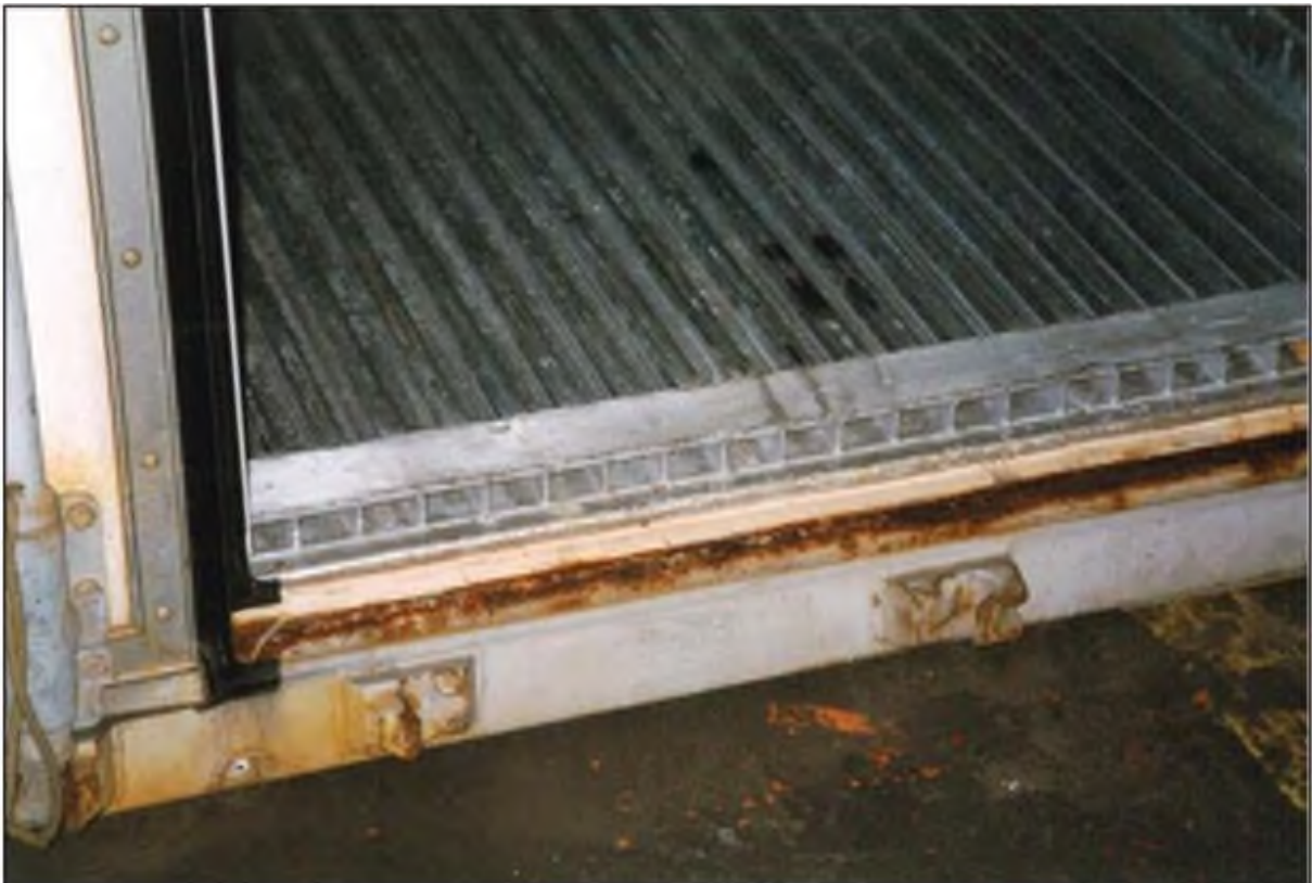
Slika 28. Rashladni kontejner s hlađenim dnom Izvor: (Piala i sur, 2016.)
