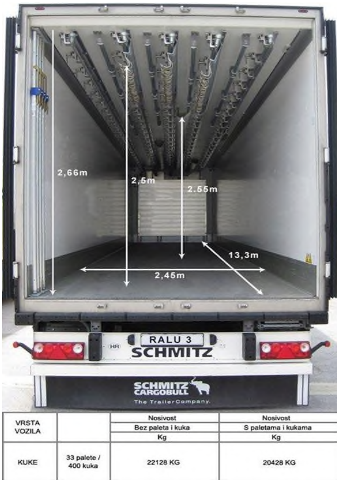
Slika 12. Kamion s rashladnim uređajem – za prijevoz mesa na kukama Izvor: ( http://www.ralulogistics.com/usluge/transport )
