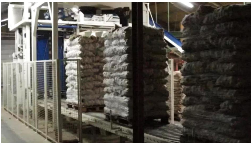
Slika 15. Paletizator vreća krumpira (Izvor: https://grapak.hr/proizvod/paletizator-symach )
