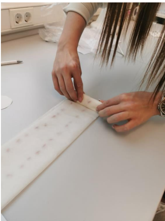
Slika 5. Zamatanje filter papira za PVC vrećicu
