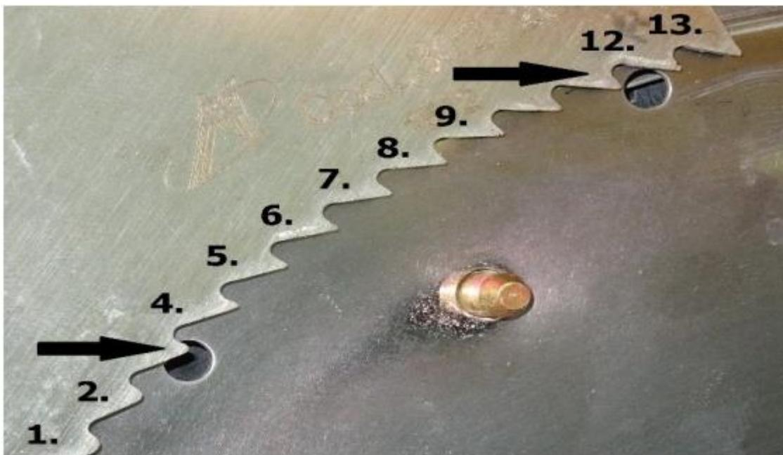
Slika 9. Skidač sjemena kod sijačice *MaterMacc Twin Row-2*
