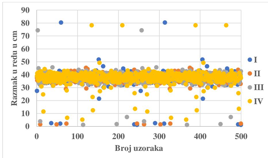
Grafikon 3. Ostvareni razmaci zrna uporabom sjetvene ploče  $n = 24 \text{ cm}$  sa položajem skidača "6".
