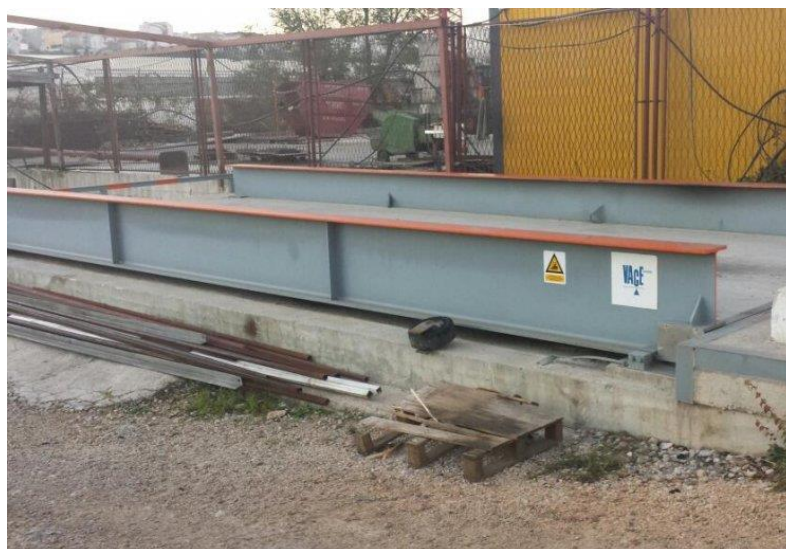
Slika 41. Digitalna mosna (kolna vaga)
