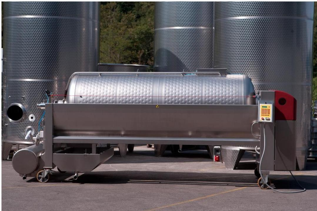
Slika 38. Pneumatska preša za grožđe
