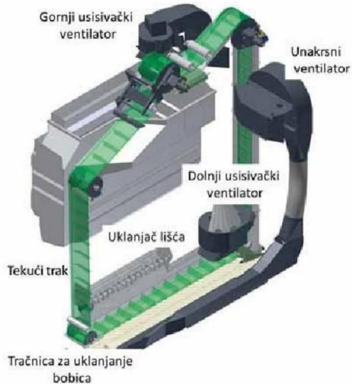
Slika 5. Shema sutava čišćenja lišća od bobica grožđa
