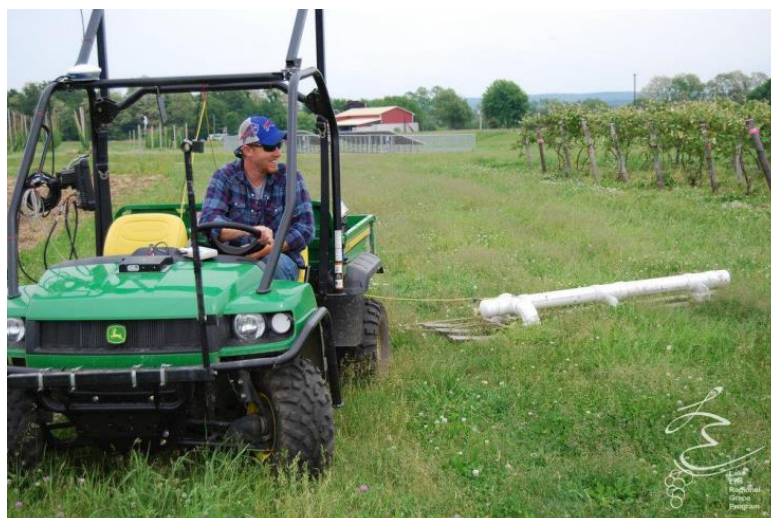
Slika 16. Mjerenje električne vodljivosti tla vinograda
