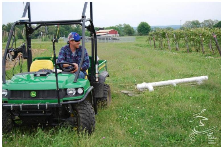
Slika 16. Mjerenje električne vodljivosti tla vinograda
