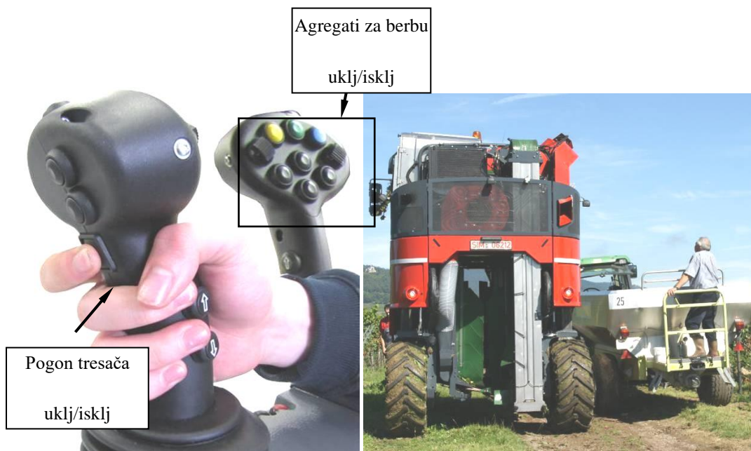
Slika 26. Upute za pražnjenje spremnika za grožđe
