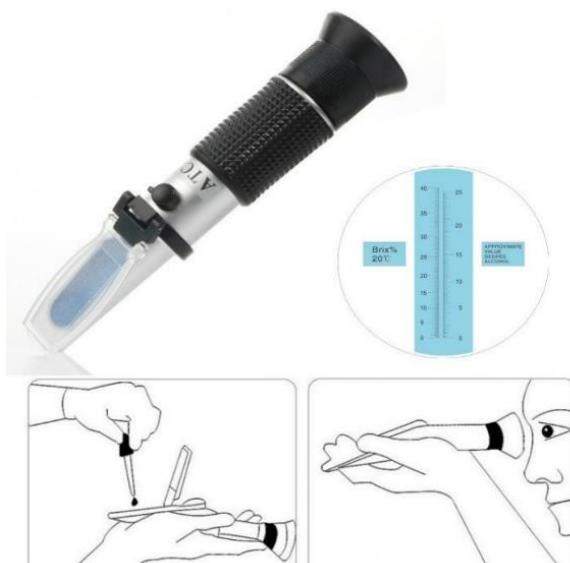
Slika 40. Refraktometar
