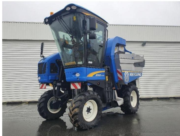
Slika 2. Samohodni kombajn za branje grožđa (*Braud*)
