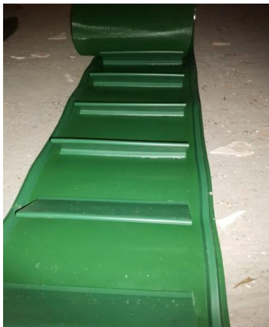
Slika 8. Nemontirana transportna traka
