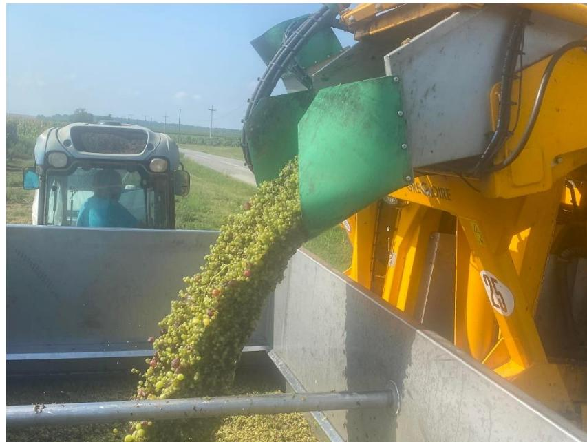
Slika 4. Prikaz istresanja grožđa iz spremnika kombajna
