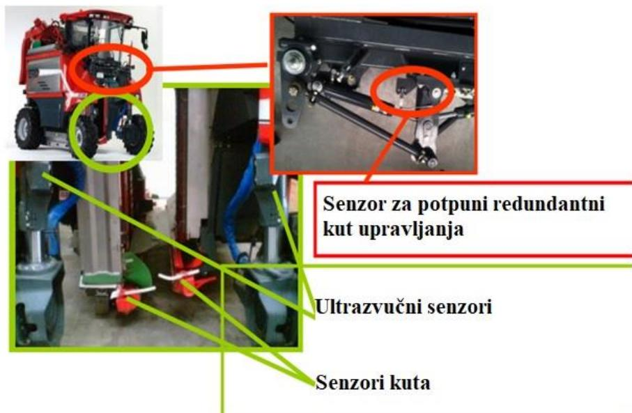
Slika 19. Senzori automatskog upravljanja
