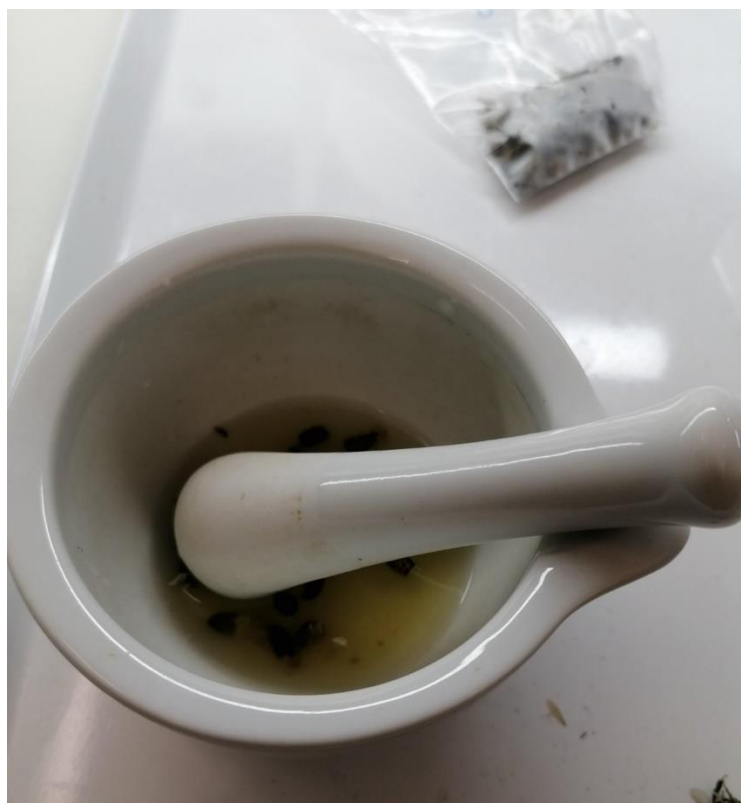
Slika 14. Priprema uzorka u tarioniku
