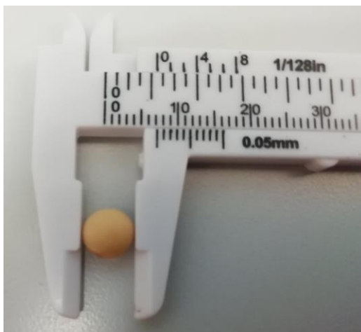
Slika 4. Određivanje promjera pojedinačnih sjemenki soje pomoću ručnog kljunastog pomičnog mjerila (Tót, 2020.)
