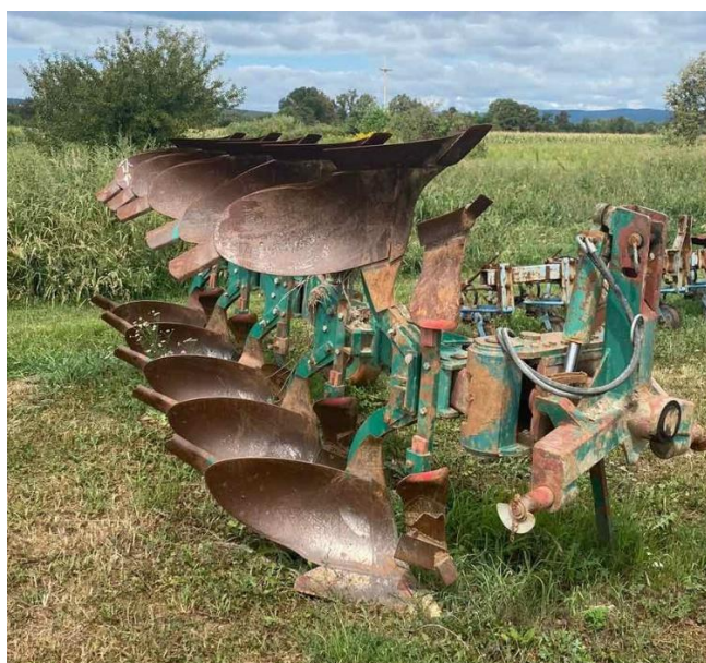
Slika 2.3. Regent Titan 15 peterobrazdni plug (izvor: vlastita fotografija)
