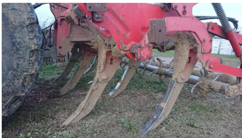
Slika 2.20. Podrivač Pegoraro MEGA DRAG 7 (izvor: vlastita fotografija)
