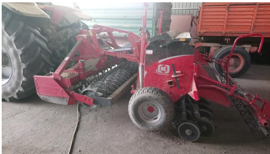
Slika 2.21. Sijačica Kongskilde PROFILINE DR23 (izvor: vlastita fotografija)
