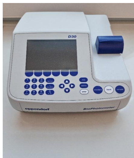
Slika 9. Eppendorf BioPhotometer D30 (Foto: Vedran Orkić)
