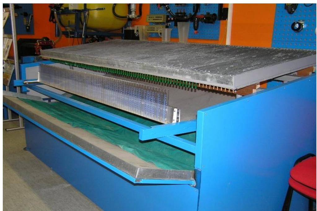
Slika 4. Ispitni stol za utvrđivanje površinske raspodjele tekućine mlaznica u Zavodu za poljoprivrednu tehniku i obnovljive izvore energije
