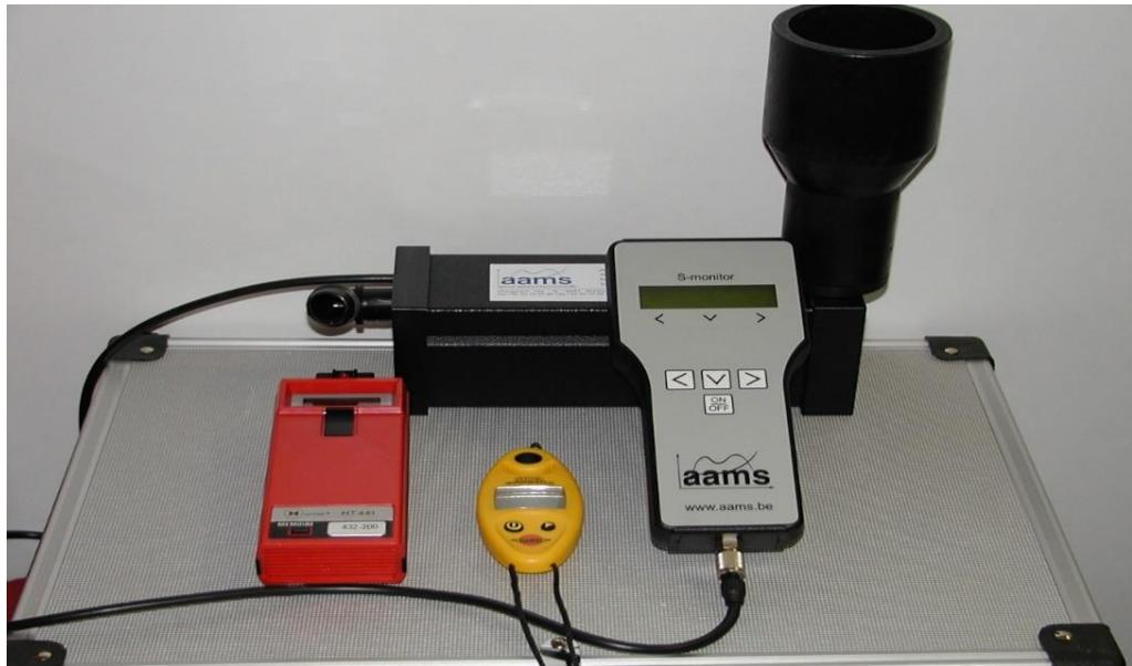
Slika 3. Uređaj za mjerjenje protoka pojedinačnih mlaznica
