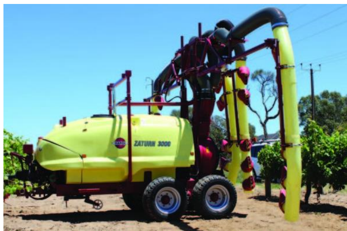
Slika 10. Traktorski vučeni raspršivač s radijalnim ventilatorom
