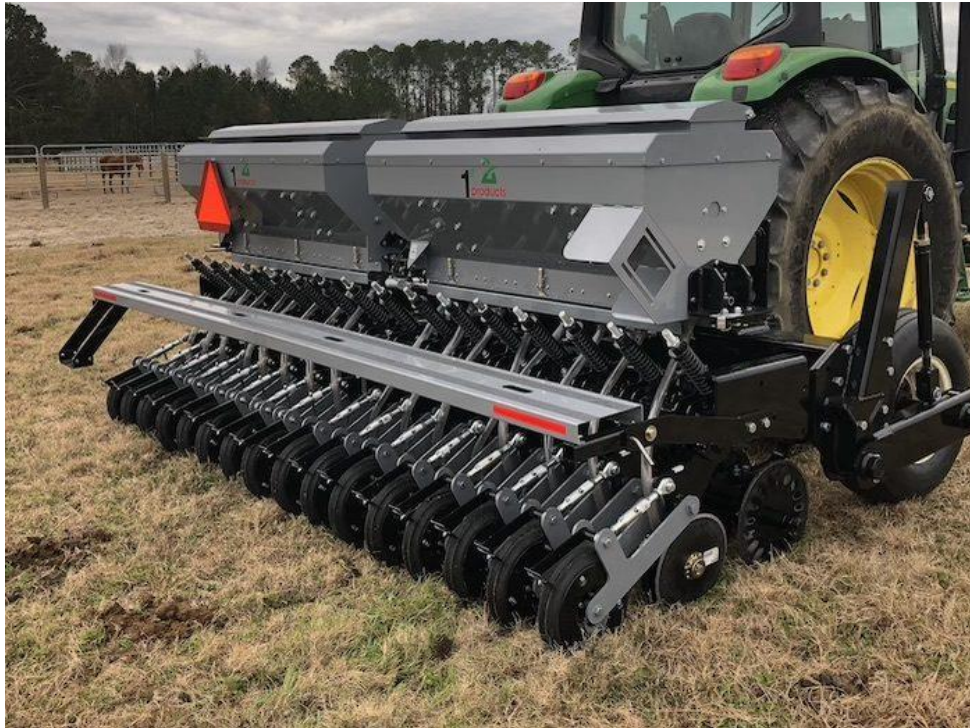
Slika 13. Posebna mehanizacija za izostavljenu obradu tla
