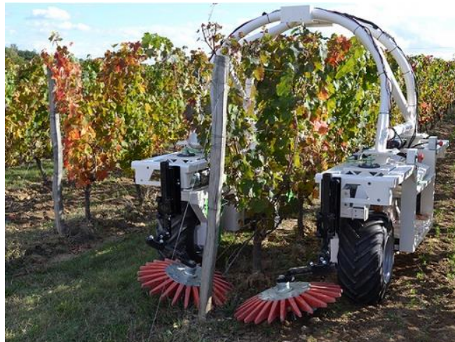
Slika 5: robot čisti unutar reda
