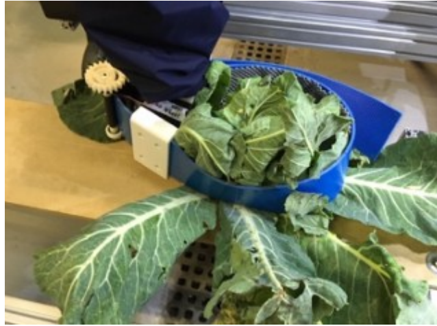
Slika 18. Robot za berbu cvjetače (Izvor: Klein, F. B. i sur., 2019.)
