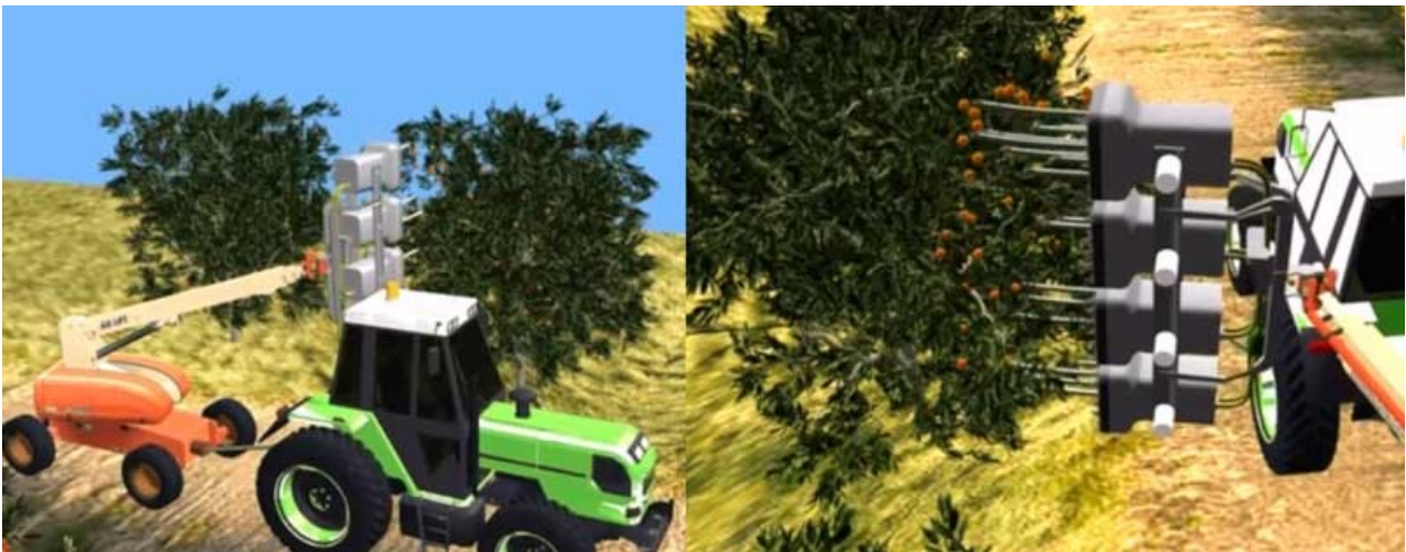
Slika 28. Prikaz rada Energida (povlačenje većeg broja agruma)
