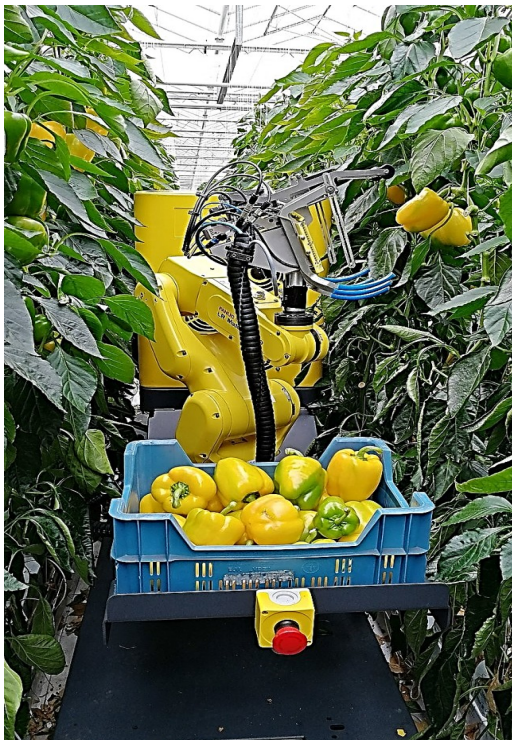
Slika 8. Robot za berbu paprike (SWEEPER robot)
