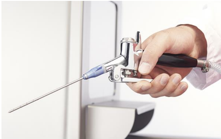
Slika 12. Ručni injektor za ubrizgavanje salamure u meso
