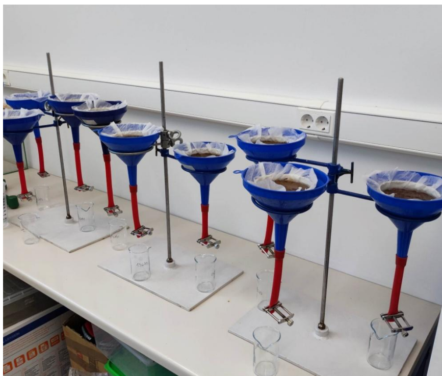
Slika 7. Ljevci za izdvajanje nematoda Baermannovom metodom (Foto: Darijo Miličević, 2022.)
