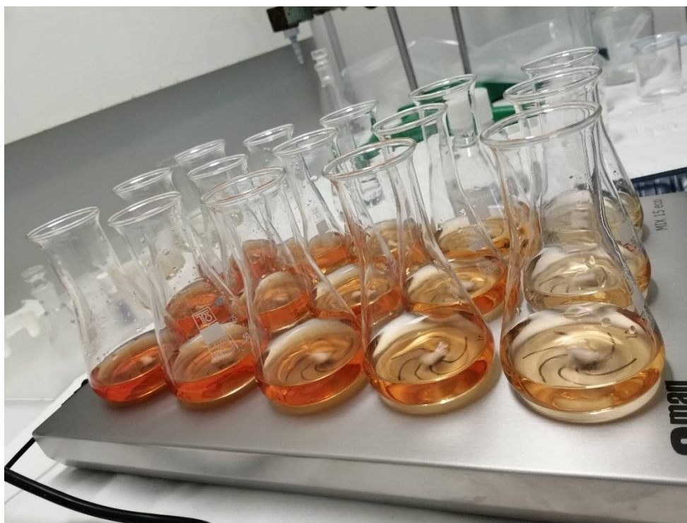
Slika 9. Sintetiziranje selenovih nanočestica (Foto: B. Ravnjak)
