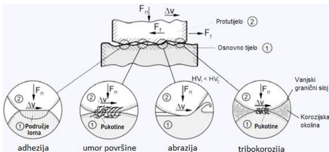
Slika 6. Usporedba osnovnih mehanizama trošenja (Kolumbić i Dundar, 2011.)
