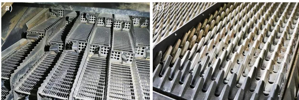
Slika 21. Trošenje slamotresa (a) i gornjeg rešeta (b) (Izvor: Agrarheute, 2018.)
