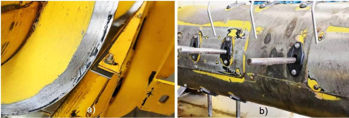
Slika 19. Trošenje spirale (a) i gibljivih prstiju (b) pužnice (Izvor: Agrarheute, 2018.)
