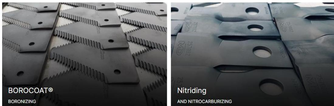
Slika 24. Borirani, nitrirani i nitrokarburirani noževi (Izvor: BorTec, 2023.)
