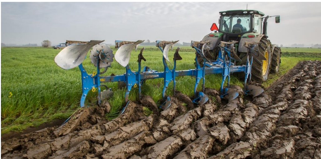
Slika 2. Konvencionalna obrada tla plugom
