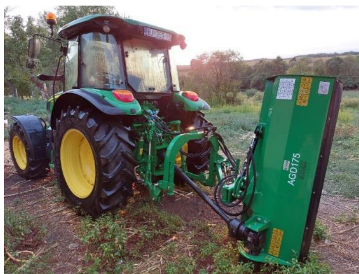
Slika 21. Mehanizacija za mehaničko uništavanje korova (Autor: Branko Pucarin)
