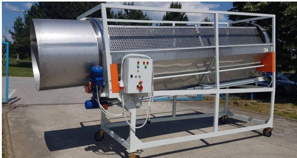
**Slika 11.** Cilindrični separator
