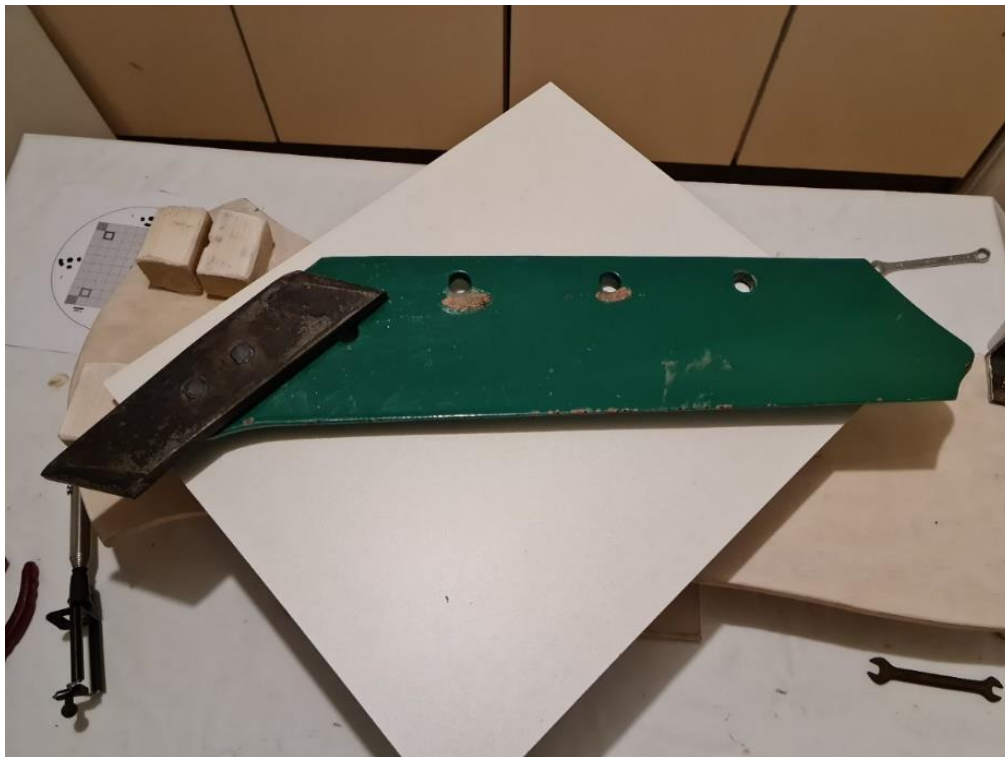
Slika 3. Novi lemeš s okretnim dlijetom
