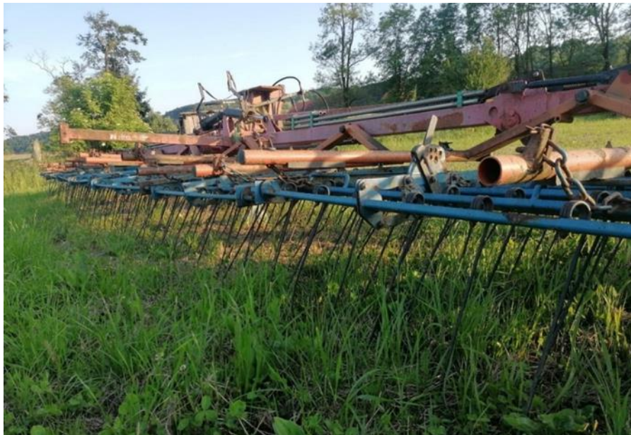
Slika 12. Česljasta drljača (štrigl)
