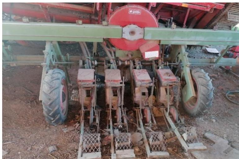
Slika 16. Pneumatska sijačica za mrkvu *Nodet*
