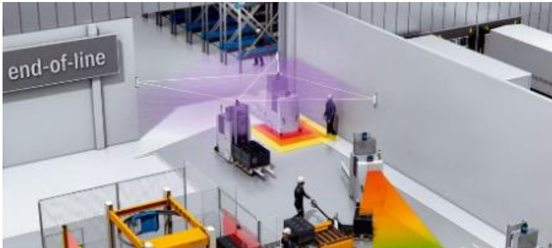
Slika 19. Navigacija u skladištu s navigacijskim skenerima LiDAR
