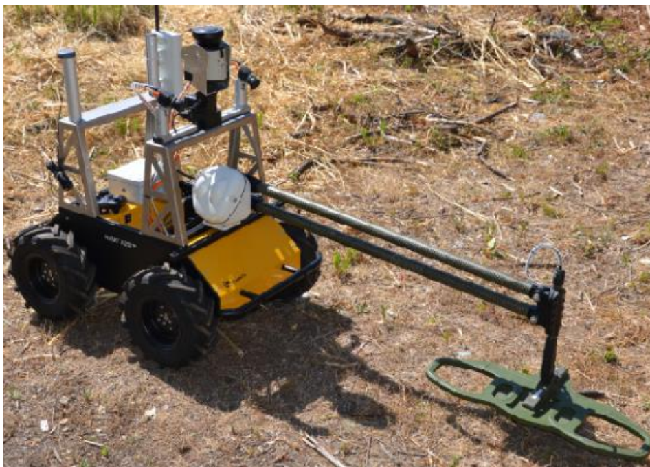
Slika 4. Teleoperativni robot za pronalaženje mina
