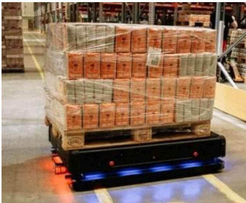
Slika 12. Prenošenje palete korištenjem autonomnih mobilnih robota
