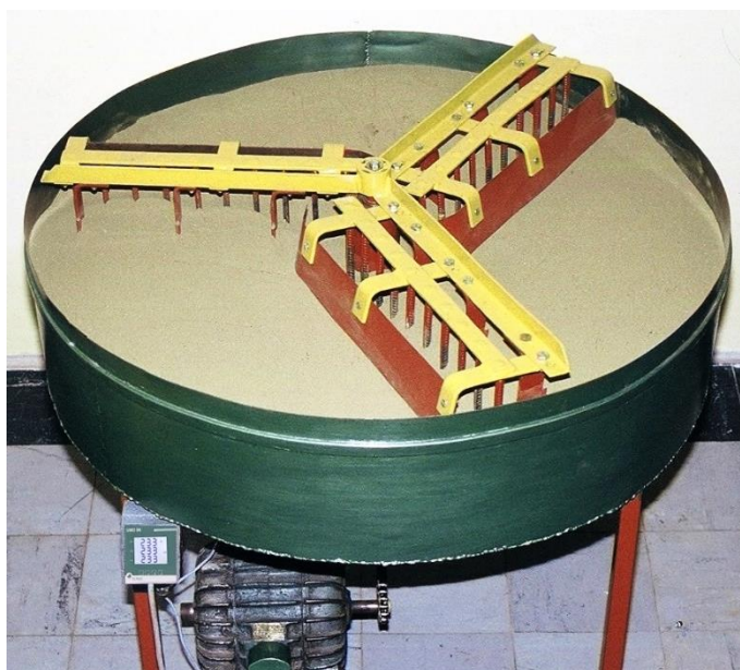
Slika 27. Uređaj za pokus trošenja (Izvor: Rašić, 2023.)
