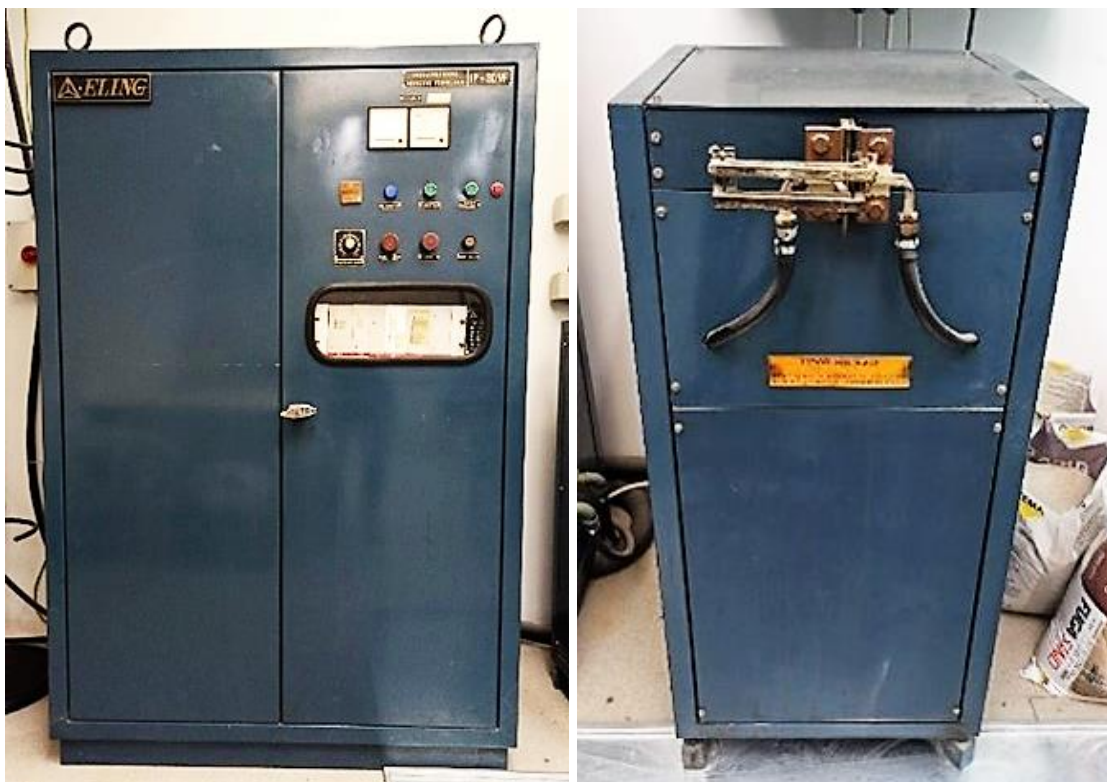
Slika 24. Uređaj za indukcijsko zagrijavanje (Izvor: Rašić, 2023.)
