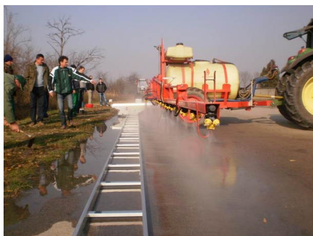
Slika 12. Uređaj za ispitivanje horizontalne raspodjele tekućine – spray scanner
