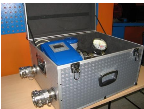
Slika 9. Elektromagnetni mjerač kapaciteta tvrtke „Krohne“
