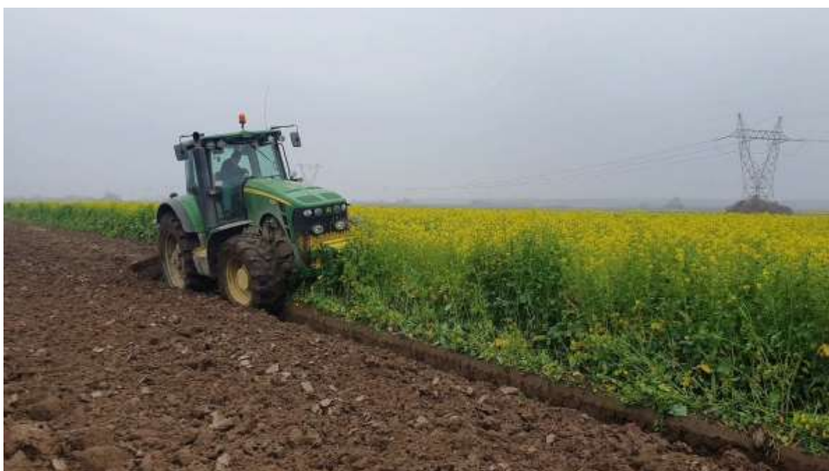
Slika 8. Slika zaoravanje biljne mase i priprema tla za sjetvu suncokreta traktorom „John Deere 8230“ i plugom „Lemken VariOpal 8“ (Zorić, 2022.)
