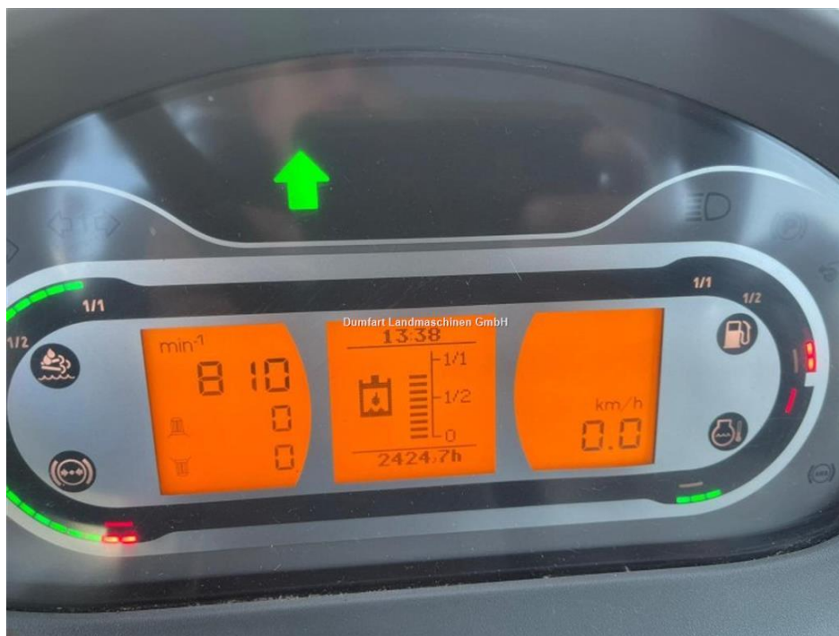
Slika 23. Potrošnja goriva pomoću SIV sustava
