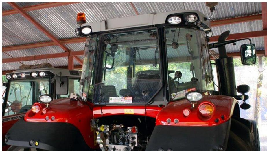
Slika 20. Reflektirajuća stakla kabine traktora
