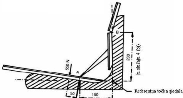
Slika 4. Shematski prikaz uređaja za određivanje referentne točke
