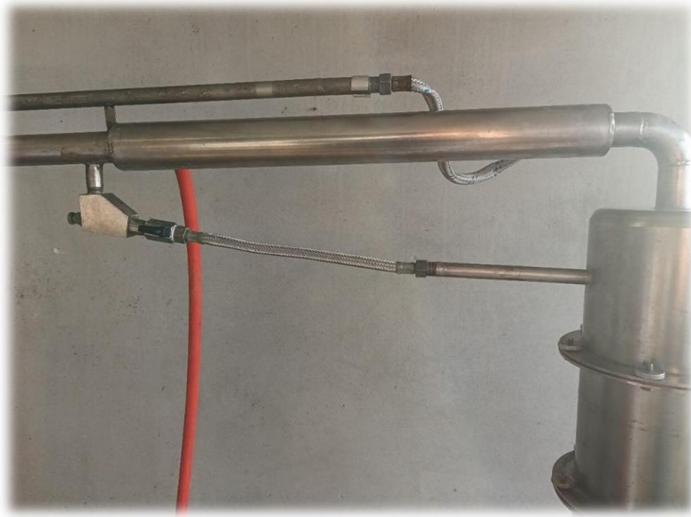
Slika 8 - Prikaz uređaja deflagmatora
