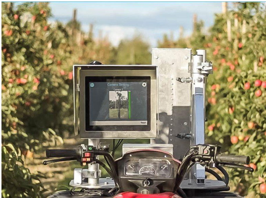
Slika 15. Sistem kamera instaliran na pokretnoj platformi (Izvor: http://www.intelligentfruitvision.com/solutions/ )
