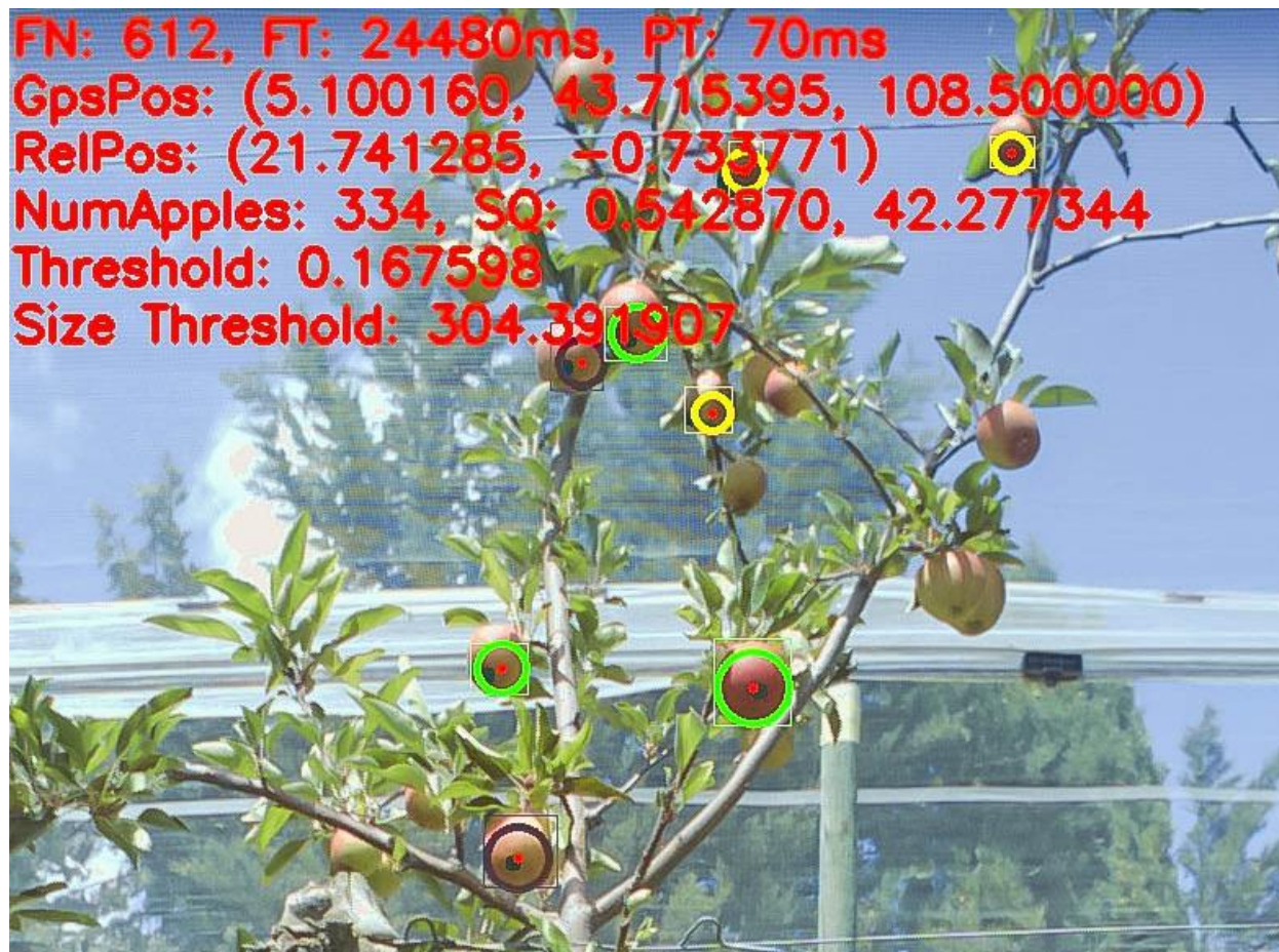
Slika 16. Obrada podataka u realnom vremenu (Izvor: http://www.intelligentfruitvision.com/solutions/ )
