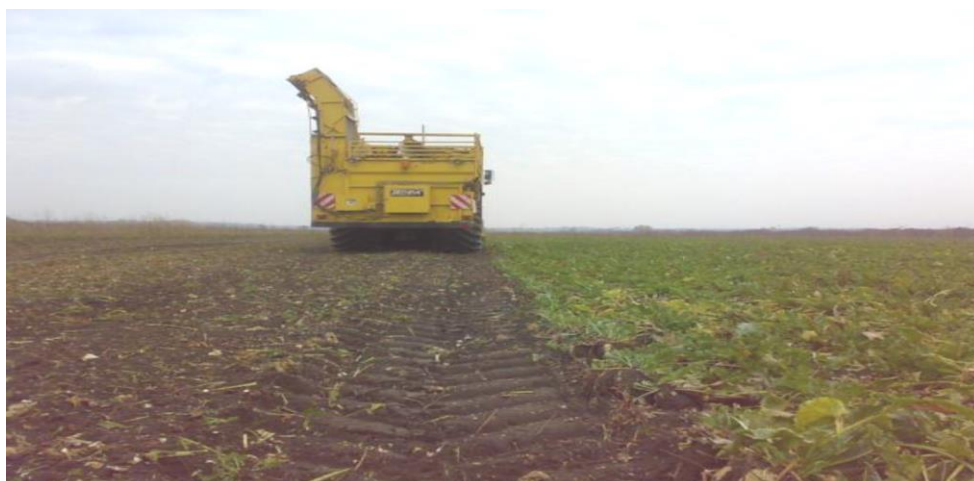
Slika 14. Kolotrazi nastali vađenjem korijena šećerne repe
