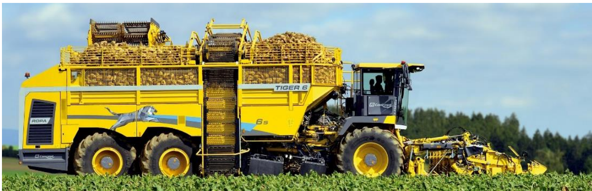
Slika 4. Suvremeni kombajn za šećernu repu ROPA TIGER-6s (Izvor: https://www.ropa-maschinenbau.de/us/products/beet-harvester/tiger-6s/ )
