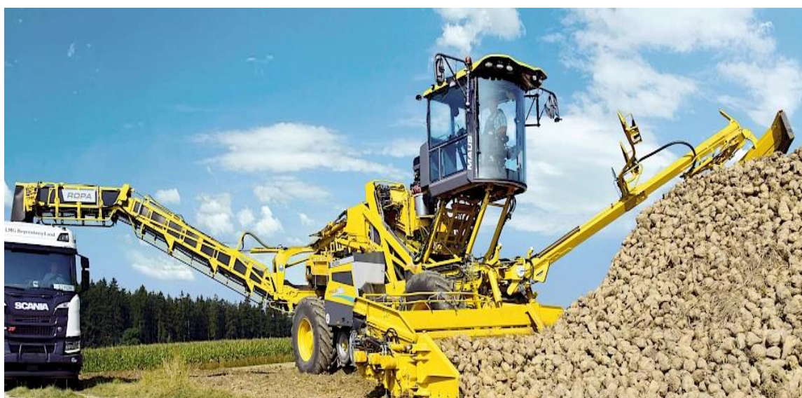
Slika 13. Pročišćavanje šećerne repe (Izvor: https://www.ropa-maschinenbau.de/en/products/ )
