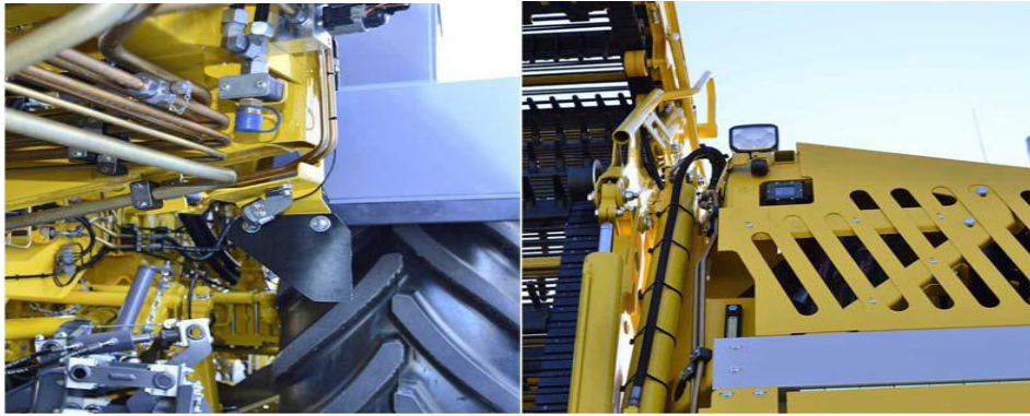
Slika 18. Kamere za „sunca“ i istovarnu traku
