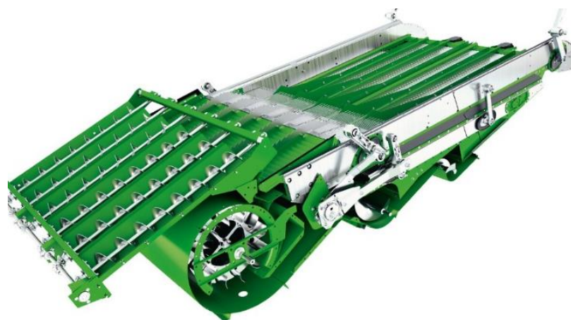
Slika 6. Uređaj za čišćenje na kombajnu John Deere serije T
