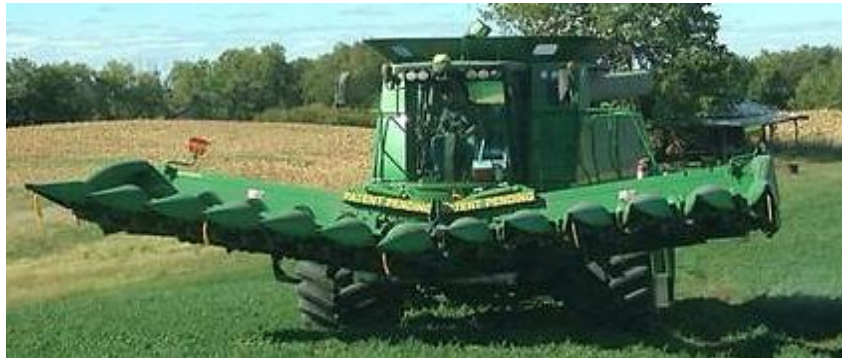
Slika 15. Split-Flex heder za ubiranje kukuruza
