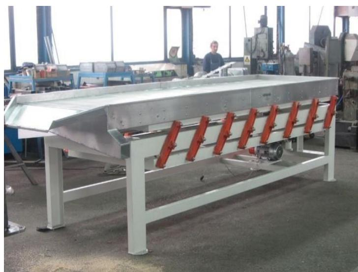
Slika 5. Vibracijska traka (<https://herbas.hr/transportna-oprema/transporter-vibracijski/>)
