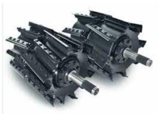
Slika 7. Noževi na bubnju (Izvor: https://www.agrima.cz/files/2011/05/fr9.pdf )
