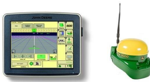
Slika 18. Satelitska antena John Deere Starfire 3000
