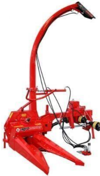
Slika 10. Traktorski nošeni silažni kombajn (Izvor: https://www.agromaster.com/en/products/harvesting-ha/ymakingforage-harvesters )
