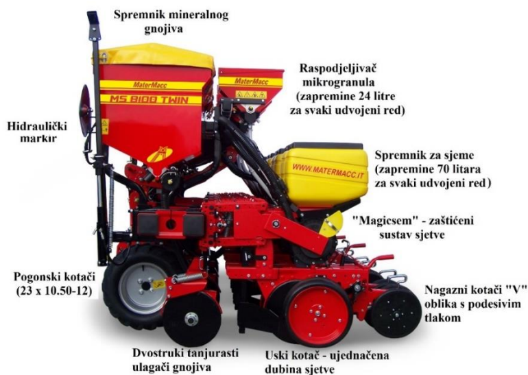
Slika 6. Glavni sustavi sijačice MaterMacc Twin Row-2
