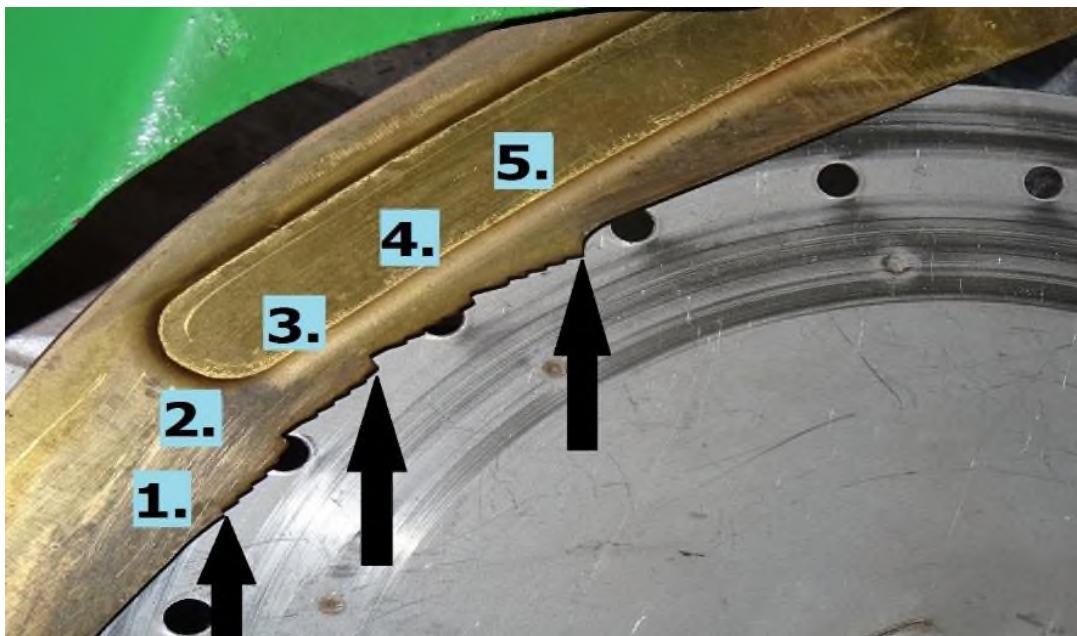
Slika 5. Položaj skidača viška sjemena na sjetvenoj ploči kod sijačice *PSK-OLT Osijek*
