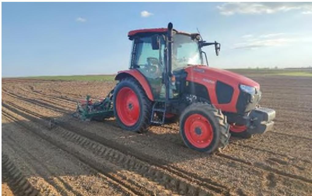
Slika 2. Sjetva suncokreta sijačicom PSK 4-OLT Osijek
