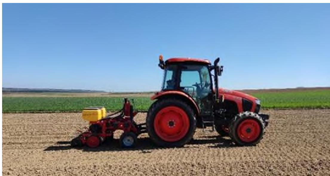
Slika 1. Sjetva suncokreta sijačicom *MaterMacc Twin Row-2*
