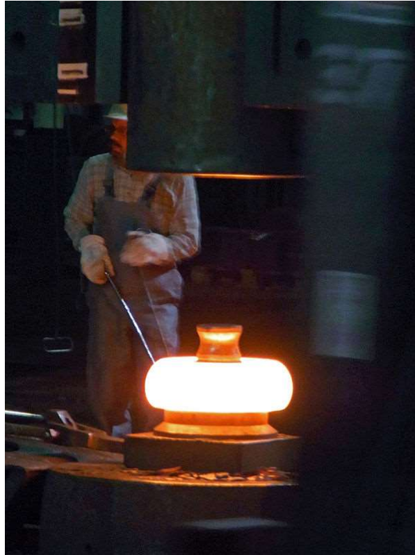
Slika 16. Postupak kovanja u toplom stanju (Izvor: https://www.wikiwand.com/hr/Kovanje )
