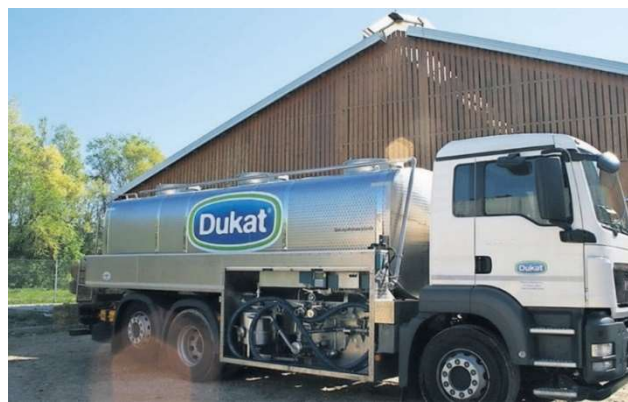
Slika 26. Autocisterna sa spremnikom od nehrđajućeg čelika
