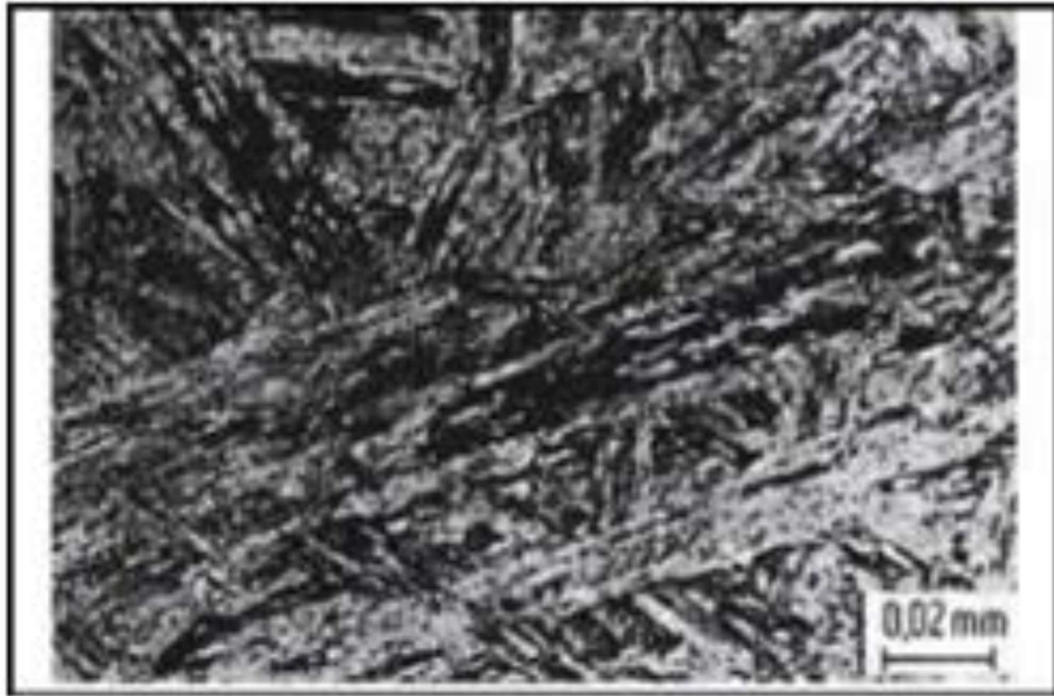
Slika 1. Mikrostruktura martenzitnog nehrđajućeg čelika
