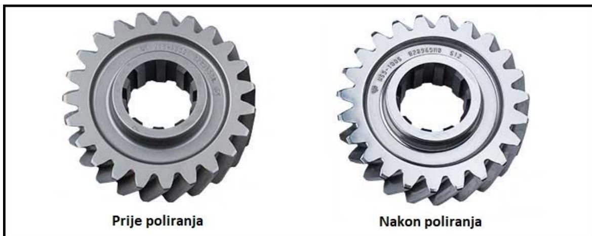
Slika 25. Zupčanika prije i nakon poliranja (izvor:
