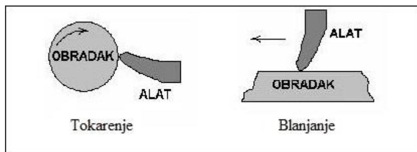
Slika 11. Shematski prikaz metode tokarenja i blanjanja (Izvor:
