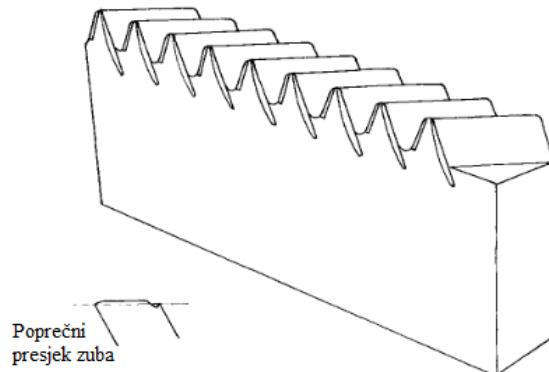
Slika 15. Rezač za bljanjanje spiralne letve (Izvor: H.J. Watson, 1970)
