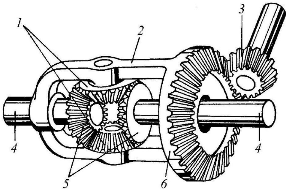
Slika 10. Shematski prikaz diferencijala (Izvor:
