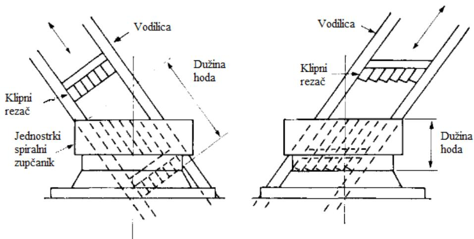
Slika 17. Shematski raspored kosih rezača u Magg metodi izrade zupčanika (Izvor: H.J. Watson, 1970)
