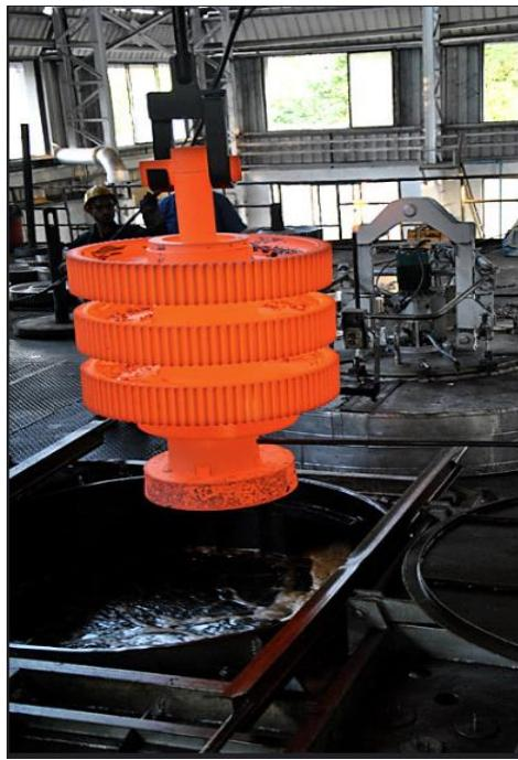
Slika 23. Kaljenje zupčanika u uljnoj kupci ( Izvor:
