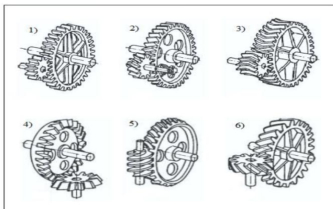
Slika 2. Osnovni oblici spregnutih zupčanika (Izvor: Dundjer, 2012.)
