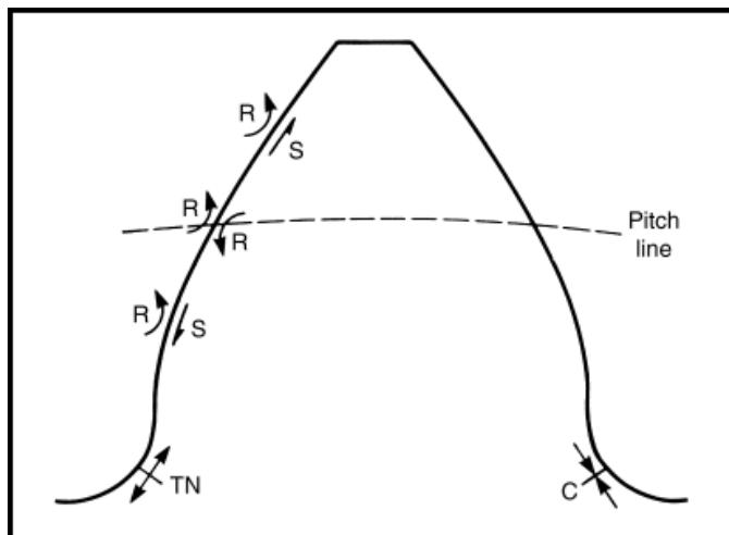
Slika 5. Naprezanja na zubu cilindričnog zupčanika (J.R. Davis, 2005).
