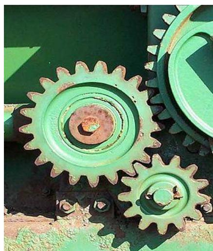
Slika 8. Sustav zupčanika za prijenos mehaničke energije (izvor:
