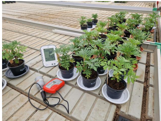
Slika 8. Uređaj za mjerenje sadržaja vode u supstratu SM150 (Fotografija: Lulić, I., 2023.)
