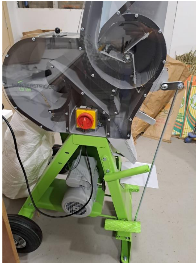
Slika 4. Vršalica za pojedinačne klasove
