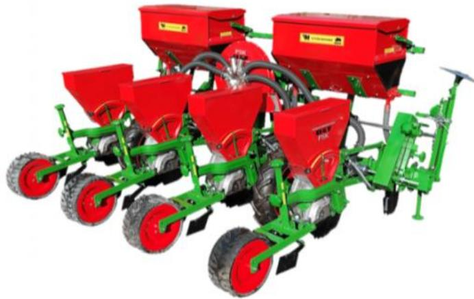
Slika 8. Pneumatska sijačica PSK
