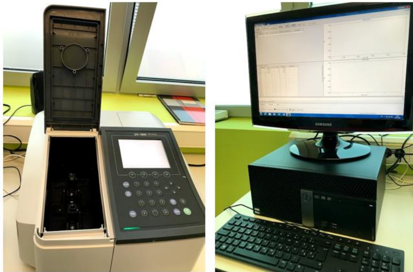
Slika 6. Spektrofotometar Shimadzu, UV-1800 (Foto: original Tihana Lovrić)
