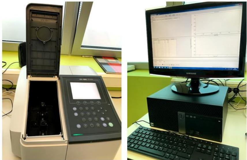
Slika 6. Spektrofotometar Shimadzu, UV–1800 (Foto: original Tihana Lovrić)
